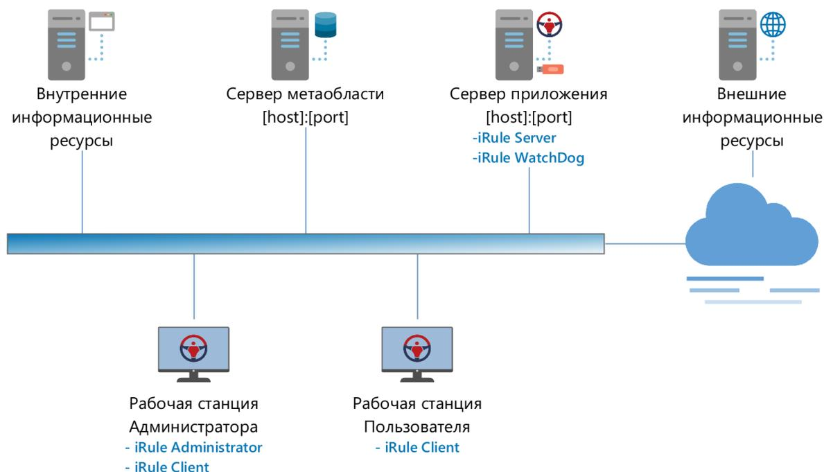
Программный продукт **iRule®** построен по трёхзвенной архитектуре: клиент – сервер приложения – сервер БД, функционирует на базе серверов и персональных компьютеров и содержит следующие компоненты:
